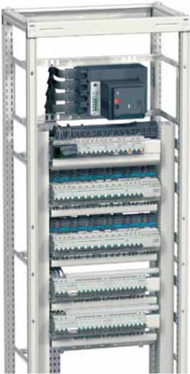
Аппарат Compact NSX400 с моторным приводом обеспечивает питание ряда устройств Multi 9 или Acti 9 через изолированные силовые шины Powerclip
